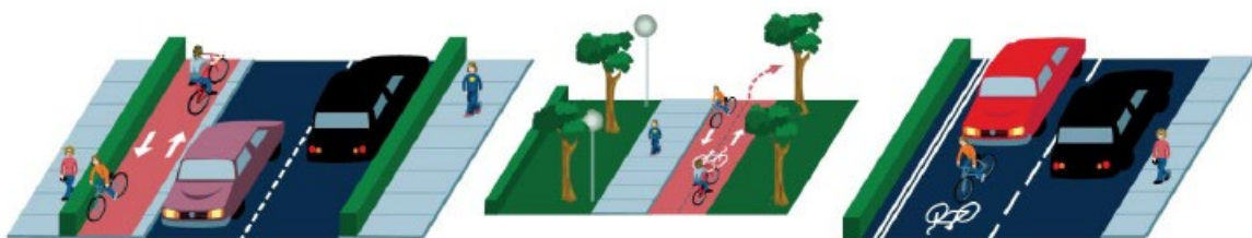
Figura 15. Tipologías de infraestructura ciclista (carril bici, sendas ciclables y ciclocalle)
